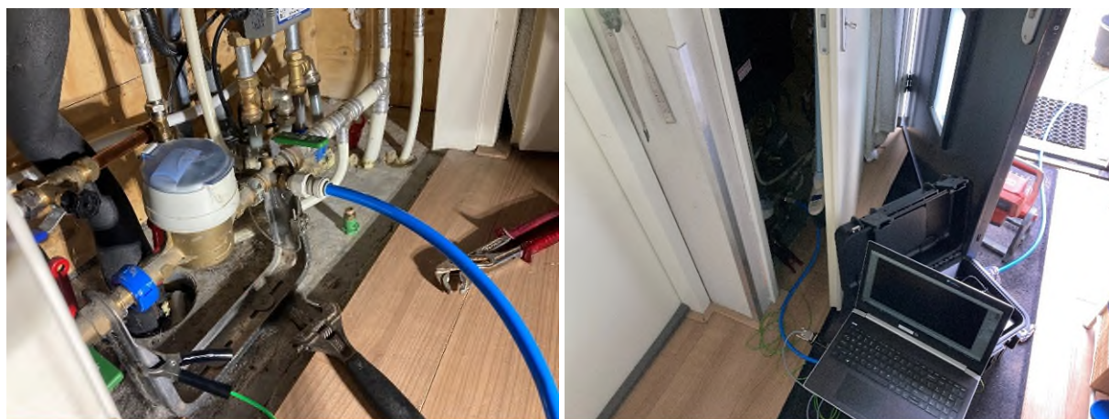
Figuur 8. Meetopstelling in actie bij huis L13. (Links) Aansluiting van de opstelling op een aftapkraantje op de hoofdkraan. (Rechts) Opstelling in de hal, met afvoer naar buiten. Merk op dat de aansluitleiding vanaf de watermeter van de voordeur afwijkt, wat betekent dat de aansluitleiding enkele meters 'binnenshuis' zal liggen.
